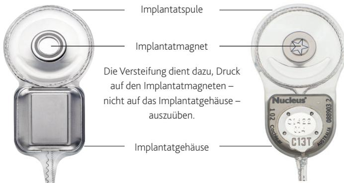
Abbildung 5: Position des Implantatmagneten bei Implantaten der CI500 Serie (linke Seite) und der CI24RE Serie (rechte Seite)
