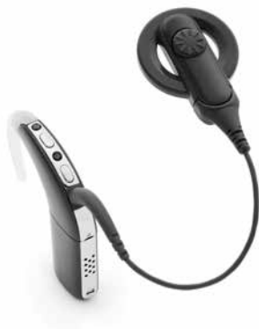
Figura 1: Procesorul de sunet CP810, emițătorul și cablul emițătorului
