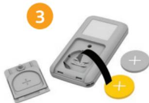
Inserte con cuidado la pila nueva con el polo positivo “+” hacia arriba.
