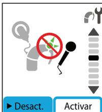
Figura 50: el indicador luminoso de recepción de sonido está desactivado (off)
