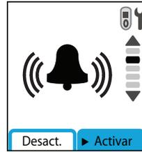
Figura 58: alarmas acústicas y visuales del mando a distancia activadas (on)
