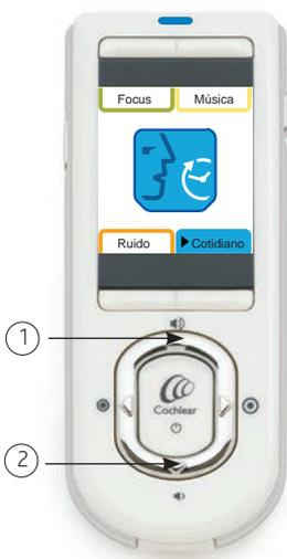
Figura 20: teclas de dirección para aumentar (1) y disminuir (2) el volumen
