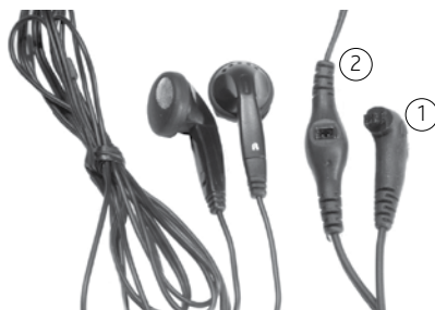
Figura 2: Connettore del processore (1) e dell'accessorio (2) sugli auricolari di controllo
