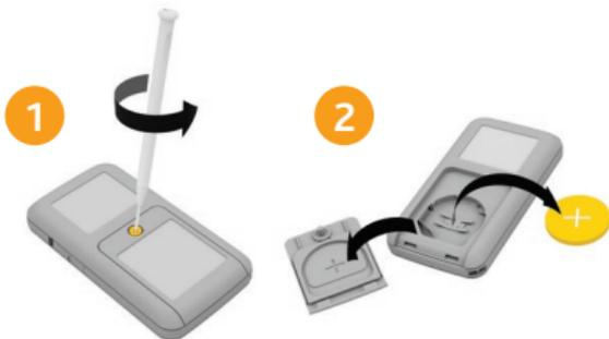
用十字头螺丝刀拧松电池盖螺丝。
