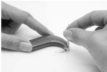
4. Poussez la broche de fixation de la corne d'oreille à l'aide de l'outil de fixation de la corne d'oreille jusqu'à ce que la broche soit entièrement insérée. Vérifiez que la broche ne dépasse pas de l'autre côté de la corne d'oreille.
