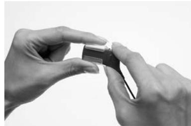
3. Insérez le module d'alimentation dans l'étui LiteWear en appuyant prudemment sur l'extrémité inférieure de l'adaptateur. Le module d'alimentation peut être inséré de deux manières.
