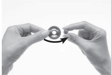
2. Tournez l'aimant dans le sens contraire des aiguilles d'une montre jusqu'à ce que vous puissiez le retirer du dessus de l'antenne.
