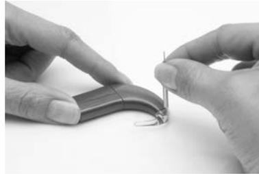
2. Insérez la broche de fixation de la corne d'oreille dans le trou de l'outil de fixation de corne d'oreille.
