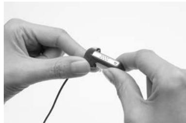
4. Maintenez le module d'alimentation et l'adaptateur inférieur du câble LiteWear (l'extrémité du câble raccordée au module d'alimentation) de manière à ce qu'ils se touchent. L'adaptateur inférieur doit être tourné vers la droite et le module d'alimentation vers la gauche de la position finale.
