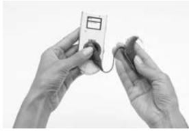
Figure 14 : Positionnement de l'antenne à l'arrière de l'assistant sans fil
