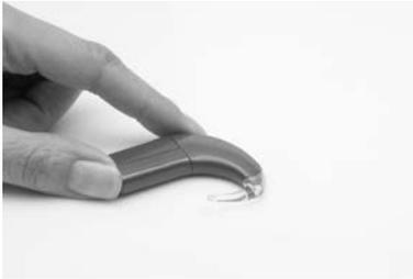
1. Fixez la corne d'oreille verrouillable sur l'unité de traitement. Assurez-vous que le trou de la corne d'oreille est bien aligné par rapport au trou de l'extrémité de la corne d'oreille sur l'unité de traitement.
