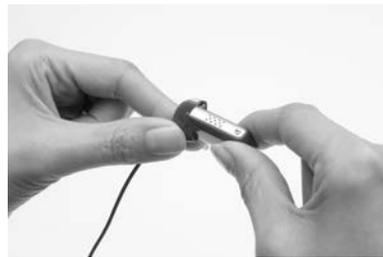
5. Tournez prudemment l'adaptateur inférieur du câble LiteWear vers la droite et le module d'alimentation vers la gauche jusqu'à ce que les deux éléments se séparent.
