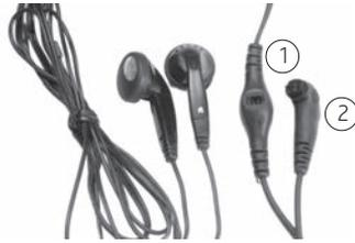
Figure 16 : Connecteur d'accessoires/système FM (1) et connecteur pour processeur (2) sur les écouteurs
