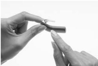
3. Vérifiez que le module d'alimentation est correctement aligné. Vérifiez que les contacts entre le module et l'unité de traitement ne sont ni cassés ni pliés, cela peut entraîner un mauvais alignement. Si des contacts sont cassés, renvoyez le processeur à votre régleur.
