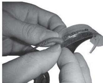
5. Insérez l'extrémité inférieure de l'outil de pose (côté muni d'une ouverture) dans le câble d'antenne.
