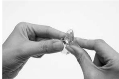
3. Alignez les crochets d'un côté de l'étui LiteWear avec ceux du système de fixation LiteWear jusqu'à ce qu'ils se touchent. Le système de fixation LiteWear doit être placé avec un léger angle.
