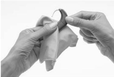
1. Essuyez le processeur avec un chiffon doux et sec avant de retirer le cache piles.
