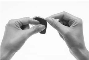
1. Placez votre pouce et votre index sur les emplacements prévus à cet effet sur l'extrémité du connecteur du câble d'antenne côté processeur.
