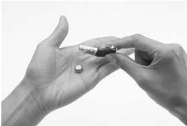
3. Retirez les piles jetables (piles zinc air) du compartiment à piles.
