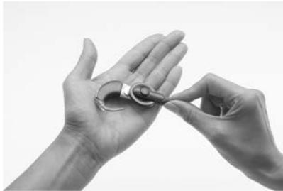
1. Placez l'aimant d'antenne sur les piles de façon à ce que l'aimant d'antenne touche les deux piles. L'aimant d'antenne attirera les deux piles hors du compartiment à piles.
