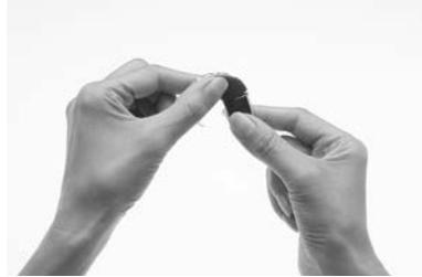
1. Tenez le module d'alimentation et l'unité de traitement de façon à ce qu'ils se touchent. Le module doit être tourné vers la gauche et l'unité de traitement vers la droite de la position finale.
