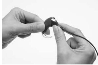
2. Maintenez l'unité de traitement et l'adaptateur supérieur du câble LiteWear (l'extrémité du câble raccordée à l'unité de traitement) de manière à ce qu'ils se touchent. L'adaptateur supérieur doit être tourné vers la gauche et l'unité de traitement vers la droite de la position finale.
