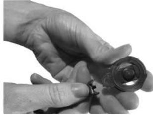
1. Tenez l'antenne et le câble d'antenne en veillant à ce que le côté inférieur de l'antenne soit dirigé vers le haut. Pour détacher l'antenne du câble d'antenne plus aisément, glissez un ongle entre l'antenne et le câble d'antenne au dessous de l'antenne.
