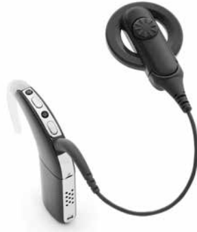
Bild 1: CP810 ljudprocessor, spole och spolens kabel
